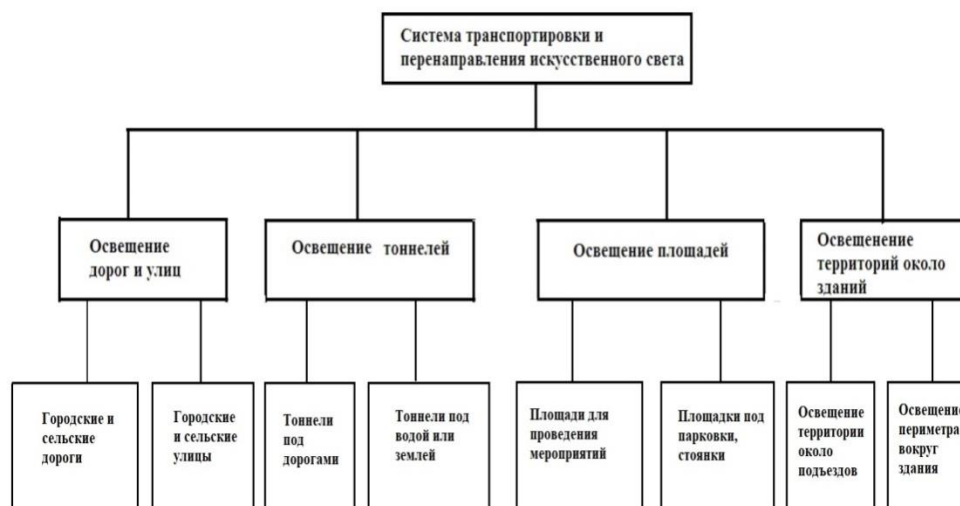
Рисунок 1-Область применения системы СИТИС –системы транспортировки искусственного света.
