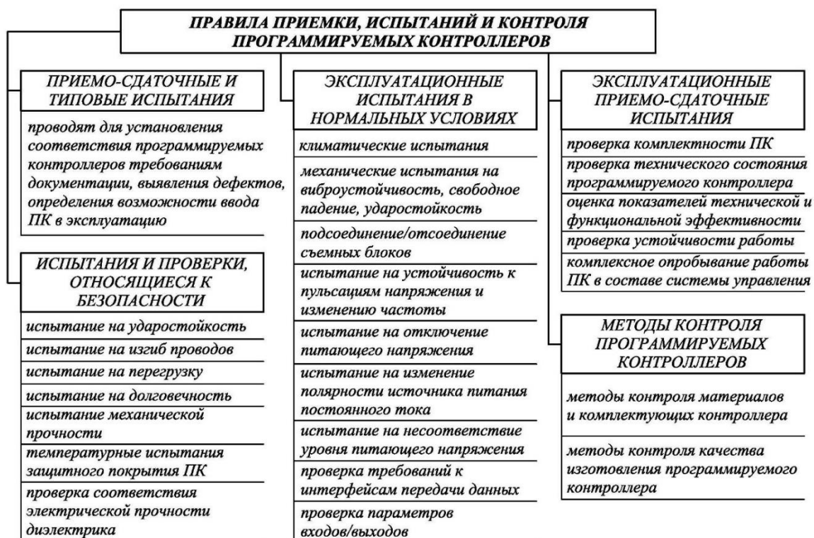
Рис.1 – Правила приемки, испытаний и контроля программируемых контроллеров
