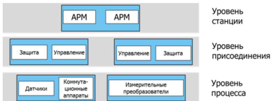
Рисунок 1 - Архитектура системы автоматизации ЦПС
