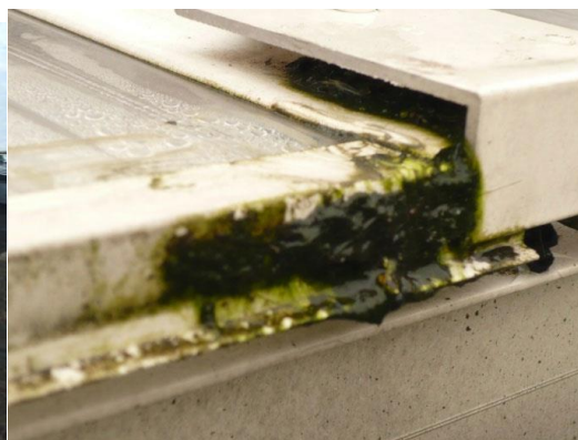
Рисунок 2- Вид образцов после 3-х летней эксплуатации зенитных фонарей.
