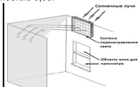
Рисунок 4- Система перенаправления солнечных лучей через потолок.
