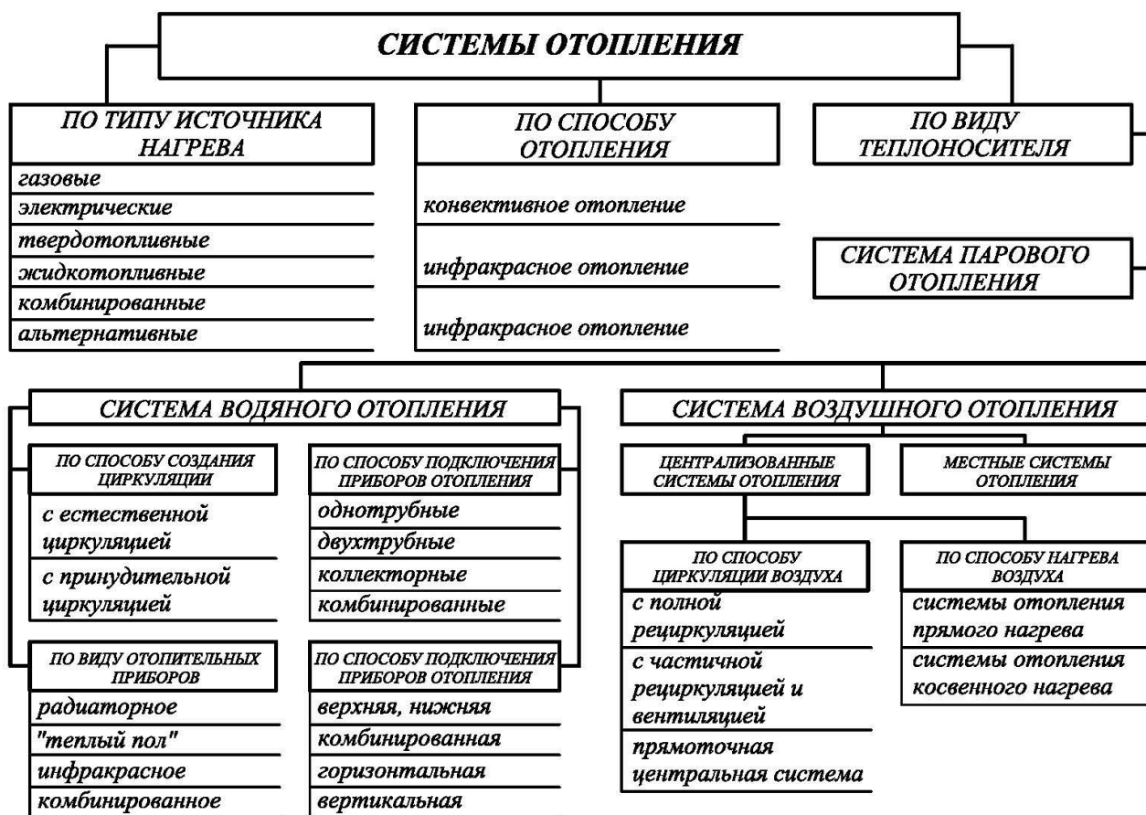
Рисунок 1 – Классификация систем отопления
