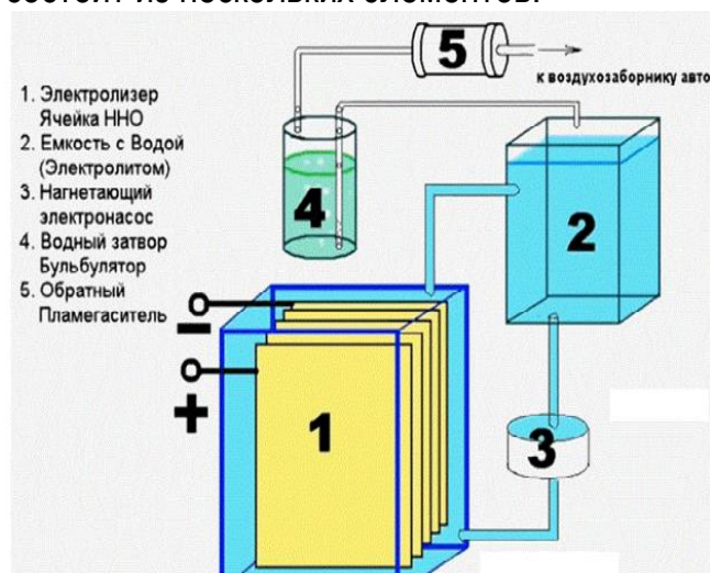
Рисунок 1 – Конструкция генератора водорода
