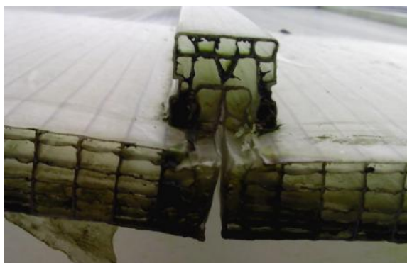
Рисунок 3- Вид образцов после 3-х летней эксплуатации зенитных фонарей, конденсат, грибок и плесень.
